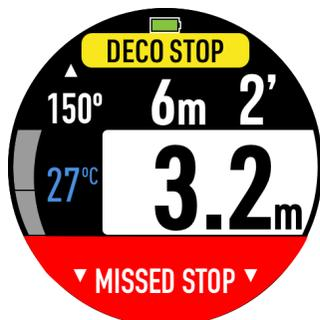
若在减压停留的深度以上将发出警报“下潜做减压”。
