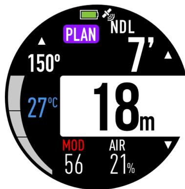
按A键、C键可调整计划深度，推算出以目前余氮量在该深度的免减压极限(NDL)
