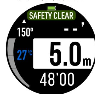
潜水深度只要超过10米，上升至6米时将触发“安全停留”。并开始倒数3分钟。
